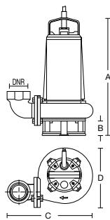
**OPTION : Pompe avec système de relevage (pied d'assise, coude et brides de raccordement pompe)**
